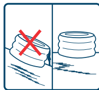
Un emplazamiento nivelado
