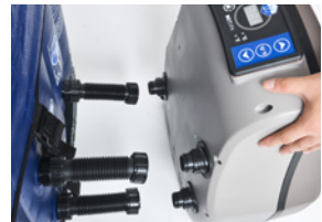
3) Lösen Sie die 3 Anschlüsse vom Motorblock.
