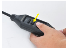
2. Drücken Sie die Reset-Taste, die Anzeige wird rot.
