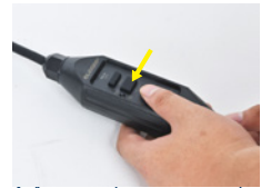
4. Appuyez de nouveau sur le bouton «RESET»; le voyant s'allume. La protection différentielle fonctionne correctement.
